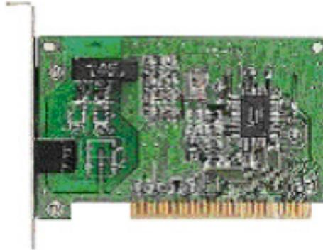
Para la conexión hace falta una tarjeta RDSI que adecue la velocidad entre el PC y la línea.
