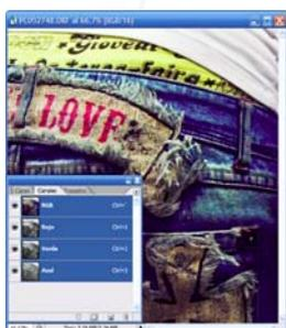
Las imágenes en el modo de color **RGB** se componen de tres canales. Cada canal es una imagen en escala de grises con una profundidad de BIT de 8 ó 16 que representan los valores de brillo para cada uno de los componentes rojo (Red), verde (Green) y azul (Blue). Con la superposición de los tres canales se compone la imagen en color.
